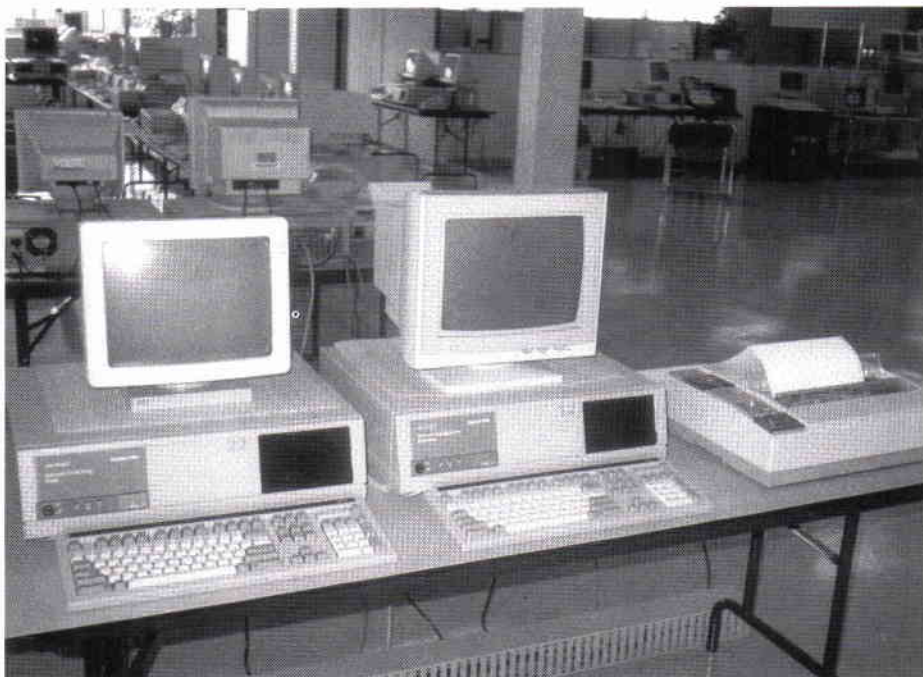
Den nya MILPAK-noden, N7000, består av två stycken WYSE PC/AT 286, en slv skärm och en färgmonitor med VGA grafik. Den vänstra utrustningen (N7400) är själva noden som ombesörjer trafiken och paketförmedlingen. Den högra utrustningen (N7900) är en så kallad NMP vilket står för Node Management Processor och den används tillsammans med skrivaren för att styra noderna och nätet.
